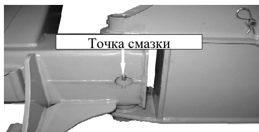
Рис. 44. Точка смазки вертикальной оси подвески смазкой STP
