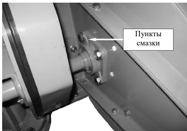
Рис. 42. Точки смазки самоустанавливающего
