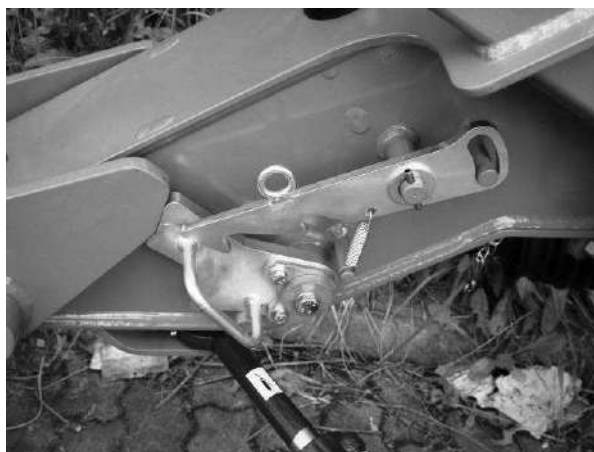
Рис. 23. Расположение защелки блокировки вне рабочей позиции
