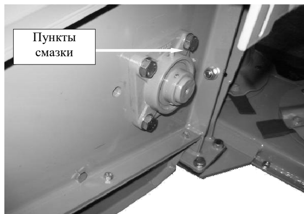
Рис. 43. Точки смазки самоустанавливающего подшипника вала впускателя смазкой ŁT43
