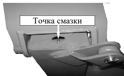
Рис. 45. Точка смазки втулки шарнира смазкой STP (вид снизу машины)
