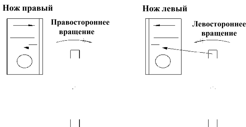
Рис. 9. Схема монтажа режущих ножей
