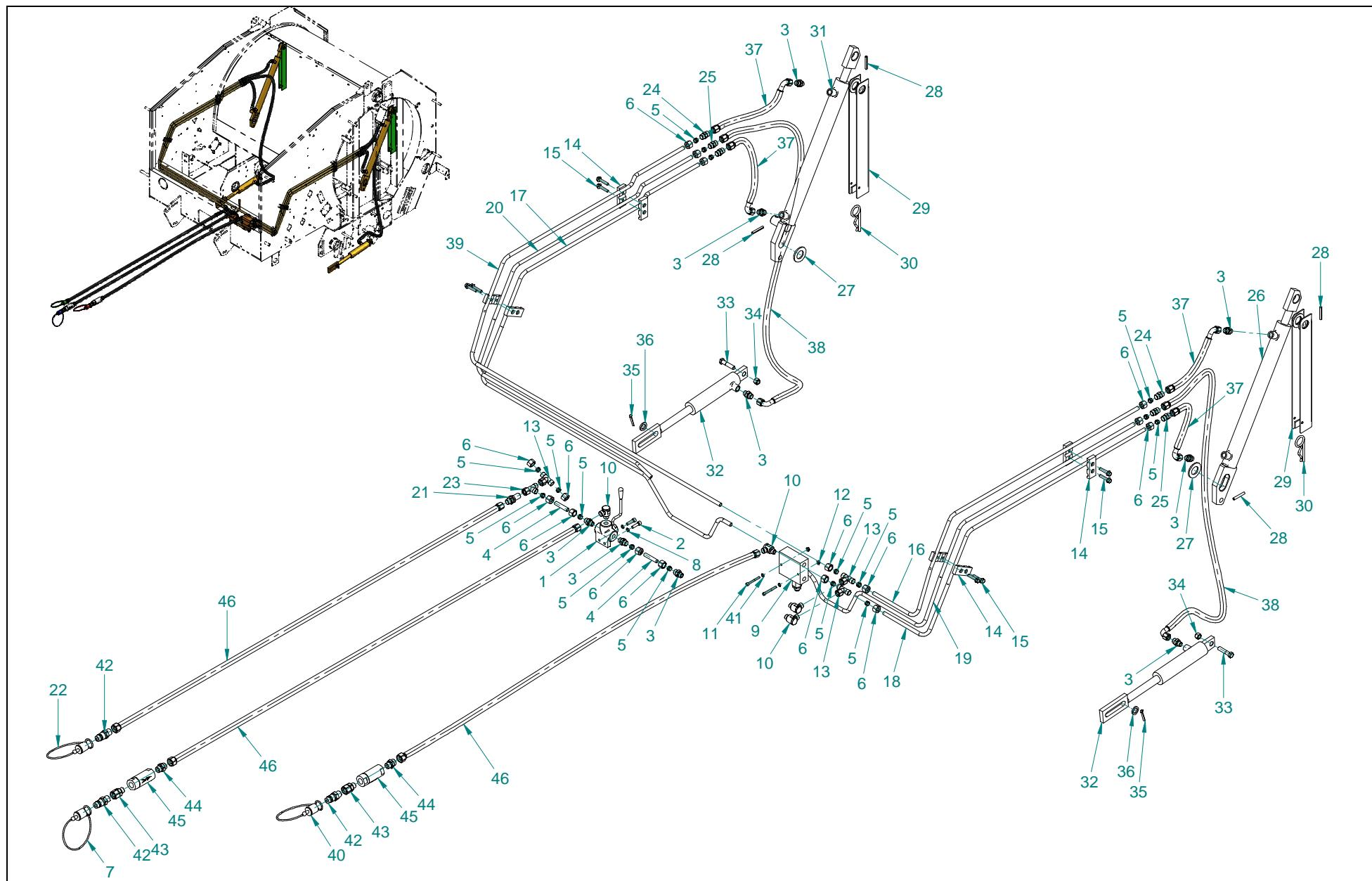
**Instalacja hydrauliczna 5569-120-500.20****Tablica 16**
