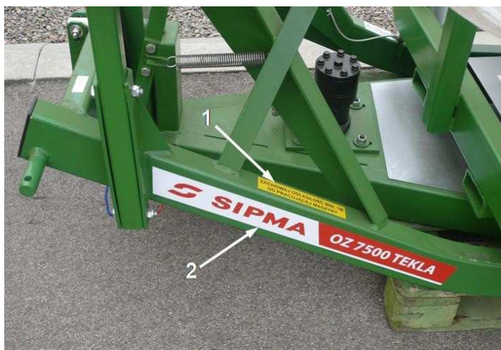
Рис. 15. Размещение наклеек – вид с левой стороны обмотчика: 1 – пиктограмма информационная; 2 – наклейка OZ 7500 P.
