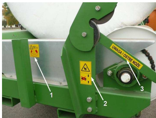
Рис. 18. Размещение наклеек – вид сзади обмотчика:
